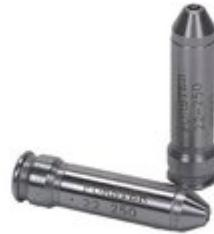
Variété de gauges : Disponibles en configurations "Go", "No-Go" et "Field", chaque gauge a un but spécifique : Gauge Go : Confirme la taille minimale de la chambre, garantissant que l'arme à feu peut chambrer et tirer une cartouche en toute sécurité. Gauge No-Go : Vérifie que la chambre ne dépasse pas le jeu maximum recommandé ; la culasse ne doit pas se fermer sur cette gauge.
