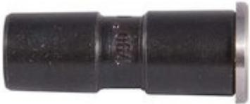
Variété de gauges : Disponibles en configurations "Go", "No-Go" et "Field", chaque gauge a un but spécifique : Gauge Go : Confirme la taille minimale de la chambre, garantissant que l'arme à feu peut chambrer et tirer une cartouche en toute sécurité. Gauge No-Go : Vérifie que la chambre ne dépasse pas le jeu maximum recommandé ; la culasse ne doit pas se fermer sur cette gauge.
