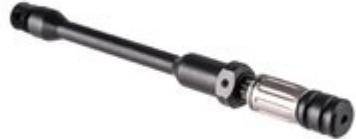
\* Les pistons Vepr et Saiga nécessiteront un perçage à travers la tige après avoir vissé le piston dans le support, en raison des variations dans l'emplacement de l'encliquetage. Ces tiges sont phosphatées au lieu d'être nitrrées pour permettre un perçage facile.\*
