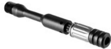
\* Les pistons Vepr et Saiga nécessiteront un perçage à travers la tige après avoir vissé le piston dans le support, en raison des variations dans l'emplacement de l'encliquetage. Ces tiges sont phosphatées au lieu d'être nitrrées pour permettre un perçage facile.\*
