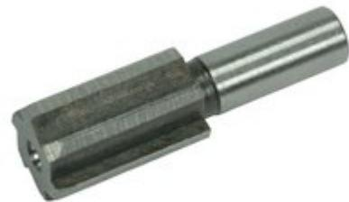
Les conversions Wildcat utilisant la balle de .224" avec un diamètre intérieur de col de .2200" et la balle de .243" avec un diamètre intérieur de col de .2390", Forster propose des reamers de col intérieur pour ces tailles. À utiliser après l'opération de dimensionnement des étuis.
